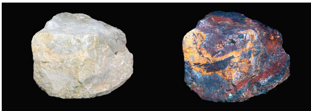
Slika7 V temnorjavih skorjastih sfaleritih iz Navršnika je bila ugotovljena povišana vrednost slednih elementov Mn in Fe. Ti deli sfalerita zelo slabo fluorescirajo za razliko od svetlejših kjer je fluorescenca izrazito rumena. Belo – modro fluorescira aragonit, 14 cm.
